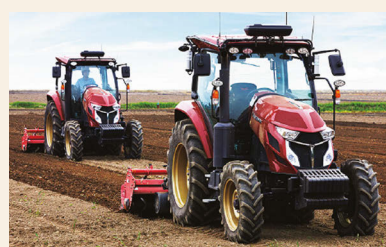
【活用例】無人自動運転による耕運作業 高精度の測位により無駄な空間なく作業が進む。
