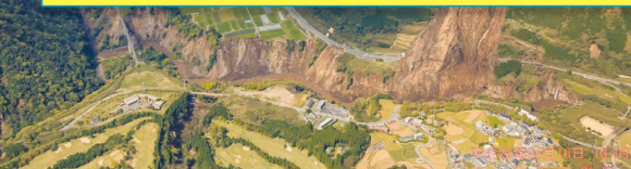
↑1 熊本地震による斜面の崩落（熊本県南阿蘇村，2016年4月撮影） 斜面崩壊により国道や鉄道が寸断され，阿蘇大橋が落橋した。
